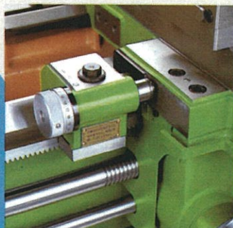
ベッドストップ ベッドに取付け、往復台を当てること により長手方向の位置決めをします。 (ただし、自動送りを停止させることはできません。)
