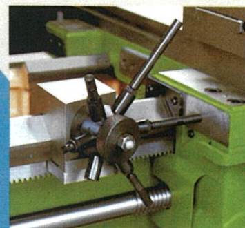
6段ストップ (MSタイプ) 6本の異なる位置決め棒により、そ れぞれ異なる長手方向の位置決めが 可能です。 (ただし、自動送りを停止させることはできません。)
