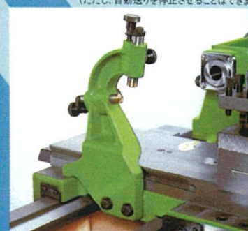
移動振止め 小径・長尺物の加工をする時、往復台 に取付け、ツールと共に移動させ、ビ ビリ防止に使用します。
